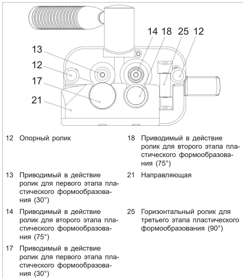
Станок – вид снизу: расположение роликов
