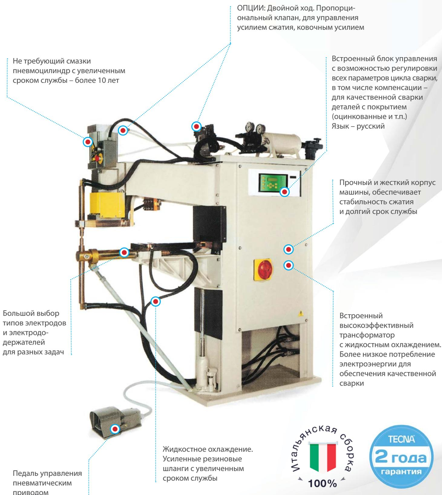
ОПЦИИ: Двойной ход. Пропорциональный клапан, для управления усилием сжатия, ковочным усилием
