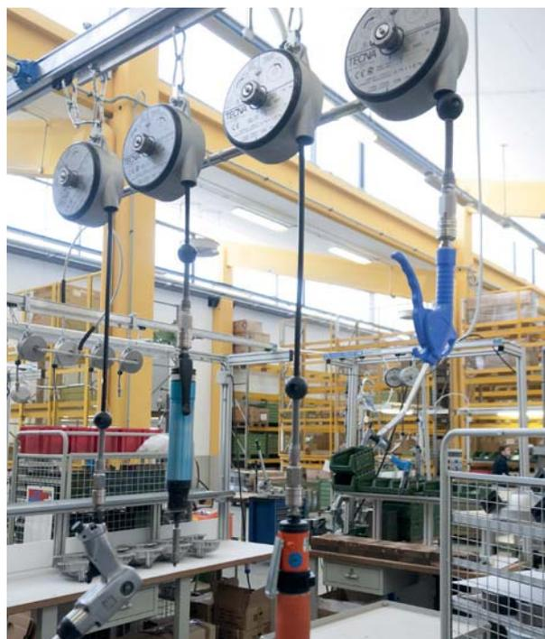
Таль-балансиры незаменимые помощники на сборочно-разборочных производственных линиях предприятий автомобилестроения, приборостроения, судостроения, мясоперерабатывающих комбинатах, производствах пищевых продуктов, автосервисах.
