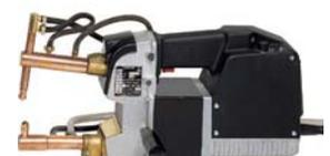
Водяное охлаждение, пневматический привод.
