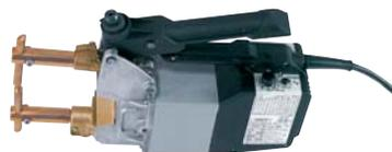
Воздушное охлаждение, механический привод.
